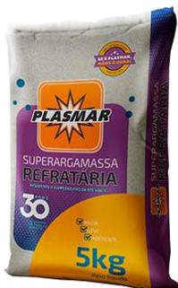
Formulada a base de cimentos especiais, agregados minerais e aditivos que conferem elevada aderência resistindo a altas temperaturas. Especialmente desenvolvida para assentamentos e rejuntamentos de forma simultânea de placas e tijolos refratários em bases submetidas a temperaturas que não excedam 400°C.
